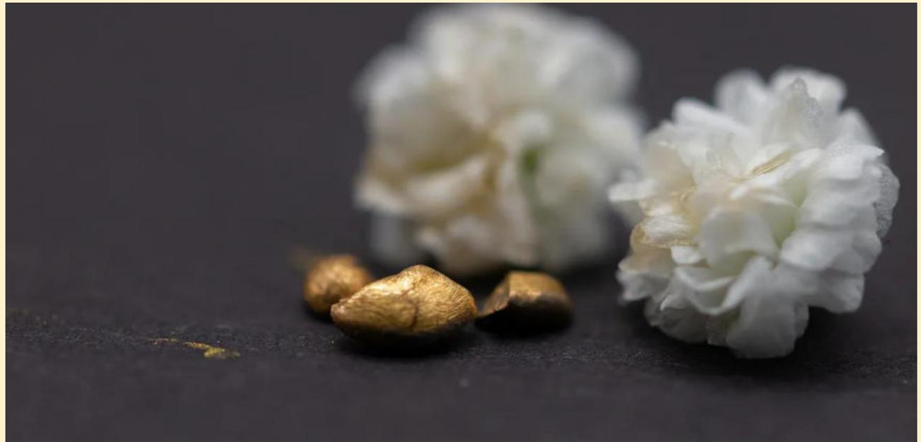
Das aus Computer-Leiterplatten gewonnene Goldnugget in drei Teilen. Das größte dieser Teile ist rund fünf Millimeter breit.
